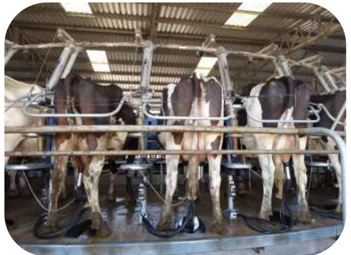
Ambos sistemas se deben instalar con retiradores automáticos. En algunos sistemas se puede automatizar el sellado, por lo que se pueden manejar con un solo ordeñador.
